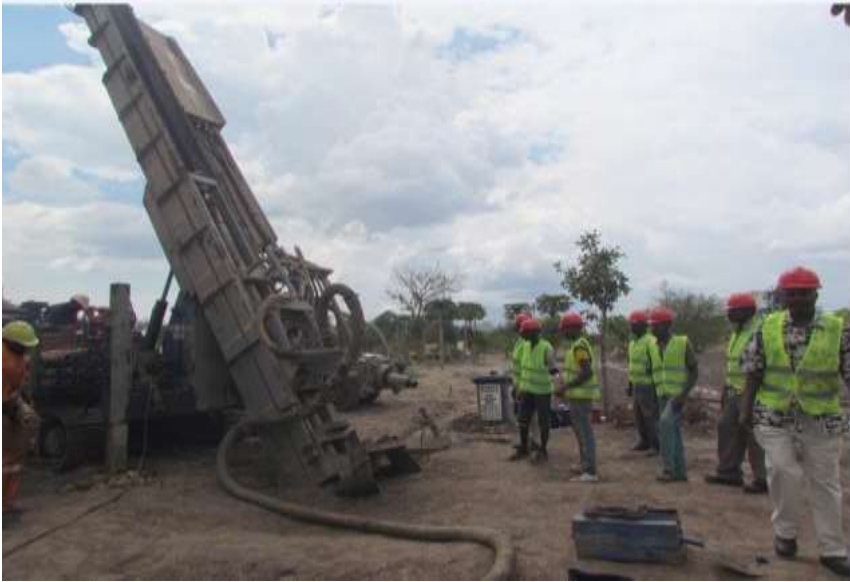
Picha Na.7: Uchorongaji kwa njia ya Reverse Circulation (RC) ukiendelea katika eneo la Itumbi - Chunya
