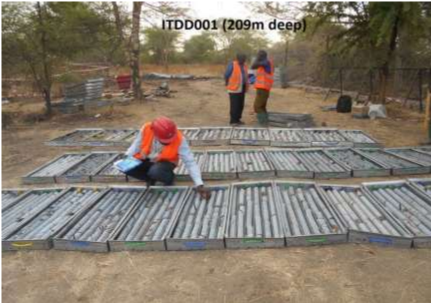
Picha Na.5: Miamba Choronge – Diamond Drilling (DD) iliyotokana na kazi ya utafiti wa madini katika eneo la Itumbi – Chunya.
