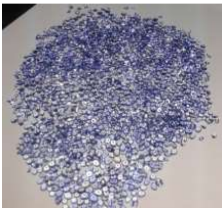
Picha Na. 12(c): Mawe ya tanzanite yenye ubora wa chini baada ya kung'arishwa kwa mashine ya tumbler na kutobolewa kwa ajili ya kutengenezea vidani.
